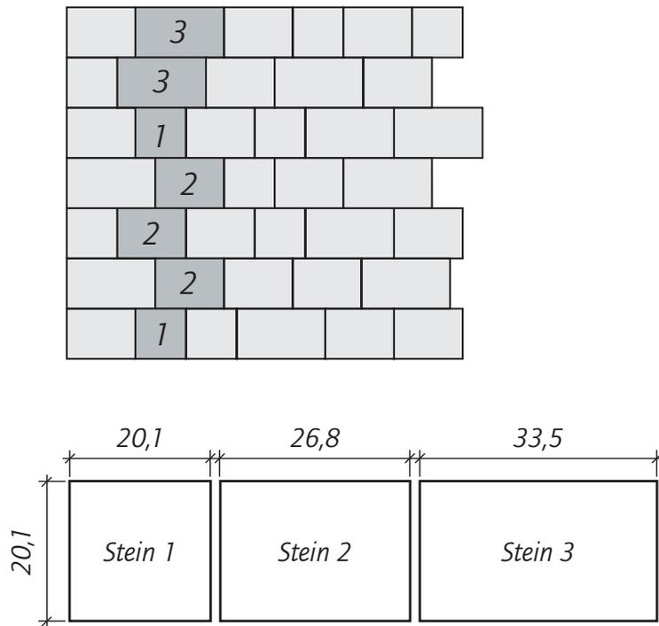
Beim Verlegen von Kromana 1-3 ist darauf zu achten, dass die Steine möglichst lagenweise von der Palette abgearbeitet werden.
