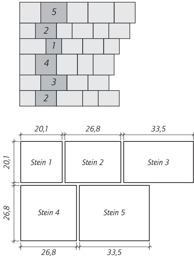
Beim Verlegen von Kromana 1-5 ist darauf zu achten, dass die Steine möglichst lagenweise von der Palette abgearbeitet werden.
