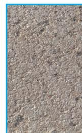
Viel (aus)gehalten: Kronimus verspricht einen nahezu vierzehnmal geringeren mittleren Masseverlust als vorgeschrieben – maximal  $0,075 \text{ kg/m}^2$ .
