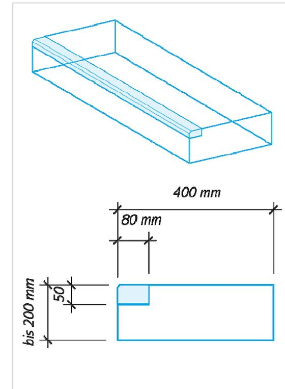
*Blockstufen mit Kontraststreifen aus Natursteinvorsatz mit sandgestrahlter Oberfläche.
