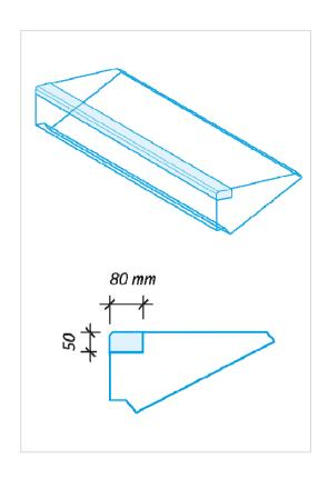
Die Auftrittsbreite und Steigungshöhe können nach genauen, beidseitigen Maßangaben angefertigt werden.
