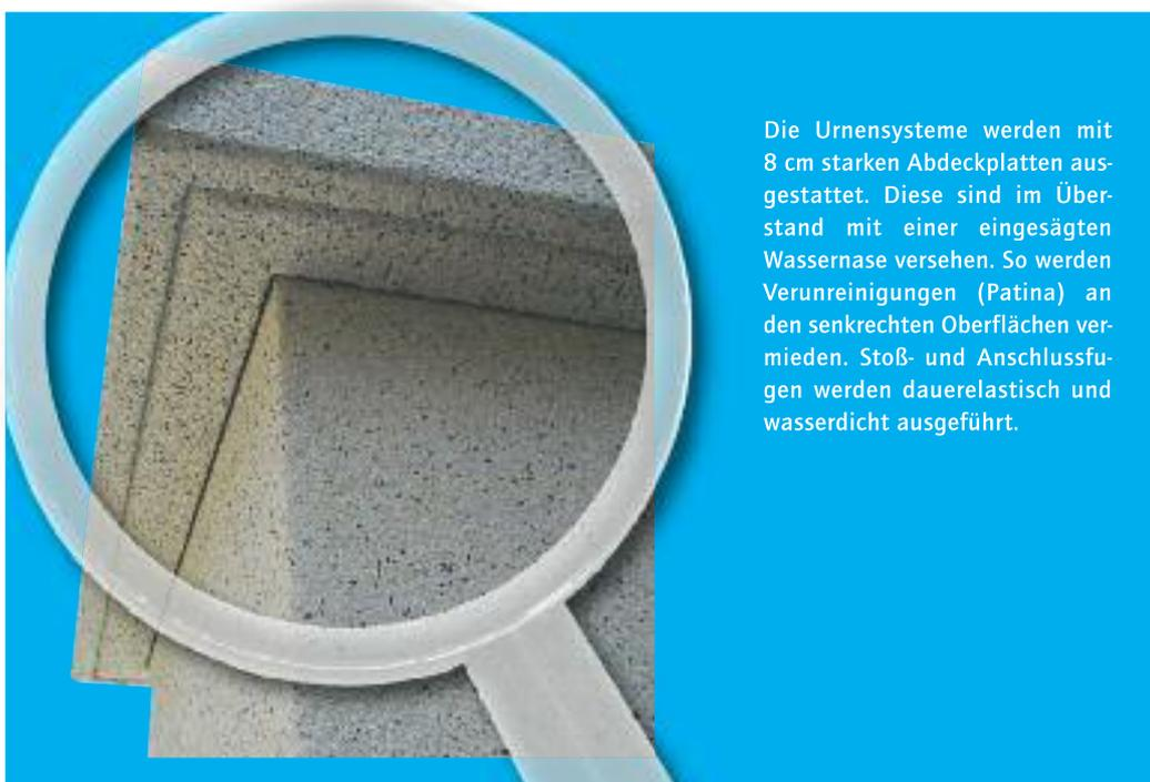
Die Urnensysteme werden mit 8 cm starken Abdeckplatten ausgestattet. Diese sind im Überstand mit einer eingesägten Wassernase versehen. So werden Verunreinigungen (Patina) an den senkrechten Oberflächen vermieden. Stoß- und Anschlussfugen werden dauerelastisch und wasserdicht ausgeführt.
